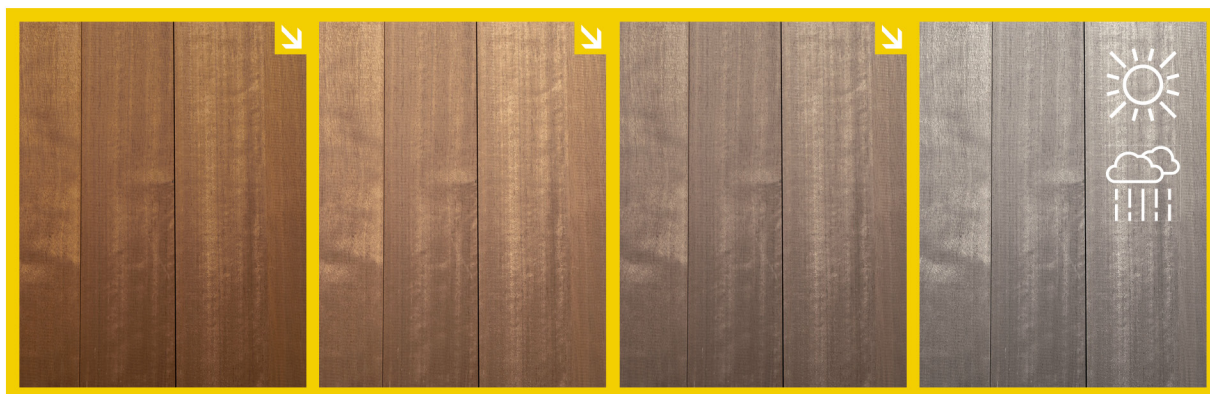
Performance - Após a instalação | Madeira sem óleo exposta aos raios UV
